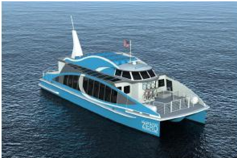
[그림 IV-2-8] Fuel cell hybrid 기술이 적용되어 2019 상용화 예정 선박
